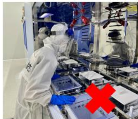
实验中将头伸进工艺槽上方
